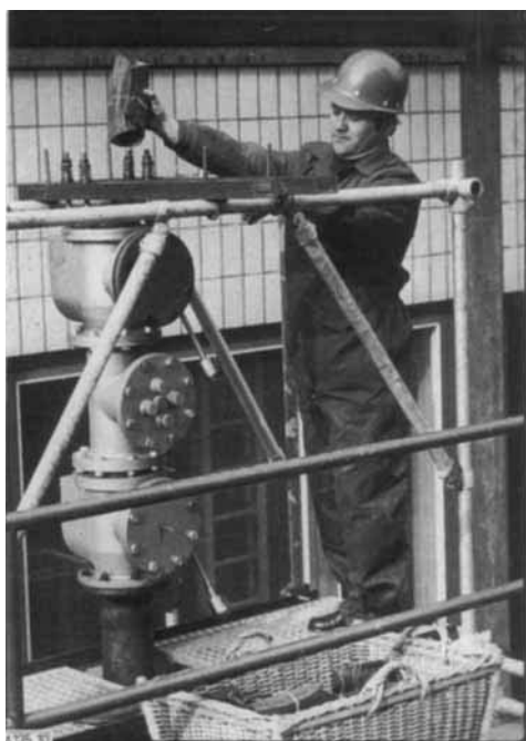
Abb. 10. Eingabe von Reifenstücken in die Schleusenkammer des Pyrolyse-reaktors (Prototyp) (Abb. 9).
